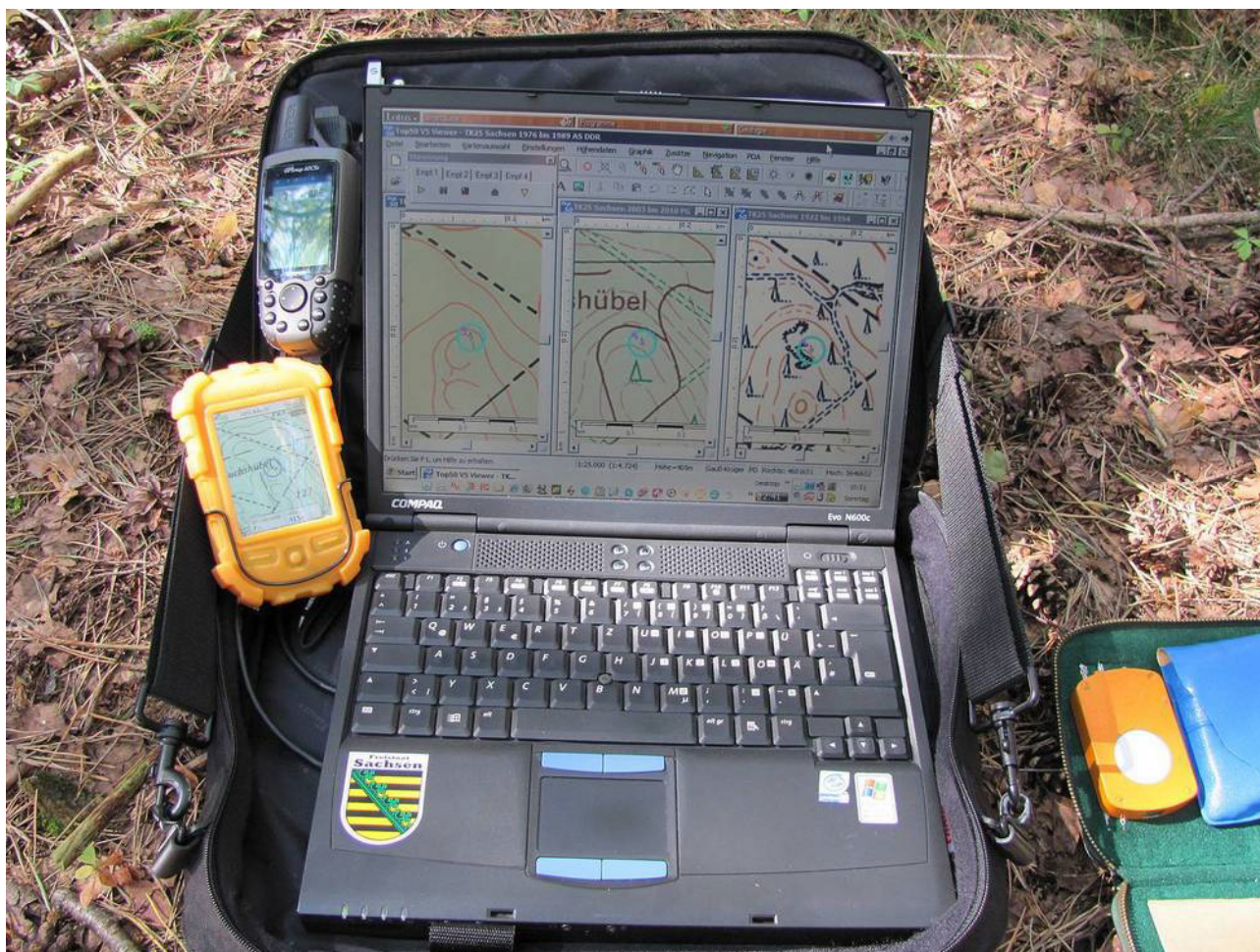
Abb. 3: Die Kartensoftware Top50 Sachsen Version 5.0 mit den stark vergrößerten und miteinander gekoppelten 1 : 25 000er Karten von 1888 (links), Stand 2008 und 1936 (rechts). Das Garmin GPSmap 60CSx (links oben) dient als Antenne. Das Satmap Active 10 in orangefarbener Silikonschutzhülle ist immer als Sologerät im Einsatz. Die blauen Kreise mit Mittelpunkt der Karten zeigen den aktuellen Standort an.
