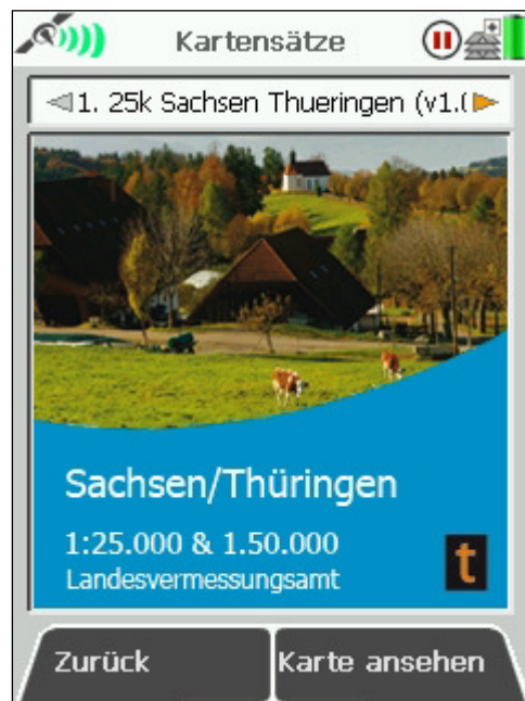
Abb. 6: Verfügbarer (eingelegter) Kartensatz bei Bedarf umschaltbar von 1 : 25 000 auf die geringere Detailstufe 1 : 50 000. Letztere Detailstufe findet bei Kartierungsarbeiten keine Anwendung.
