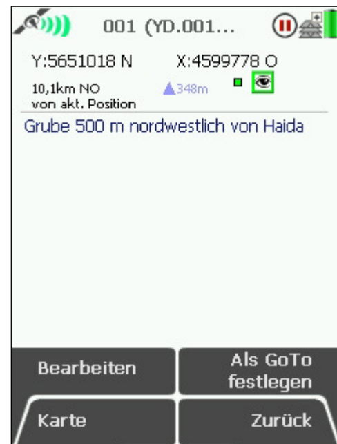
Abb. 9: Die kurze Beschreibung inklusive Koordinaten des Aufschlusses Nr. 001 (YD.001....1988) wird beim Exportieren der Aufschlüsse von der PC-Kartensoftware mit in den Active 10 übertragen. Es ist nicht sinnvoll den Text im Feld einzutippen, da die Daten bereits handschriftlich im Feld-/Aufschlussprotokoll stehen und deren Erfassung am PC generell noch erfolgt.
