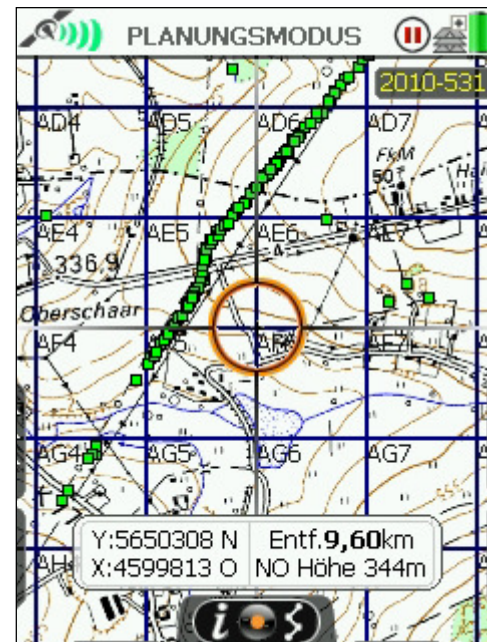
Abb. 13: Text auf S. 75. Das Active 10 bietet eine interessante Funktion, wobei ein Gittersystem mit eigenen Planquadrat-Bezeichnungen auf die Karte projiziert wird. Hier im Maßstab 1 : 25 000.
