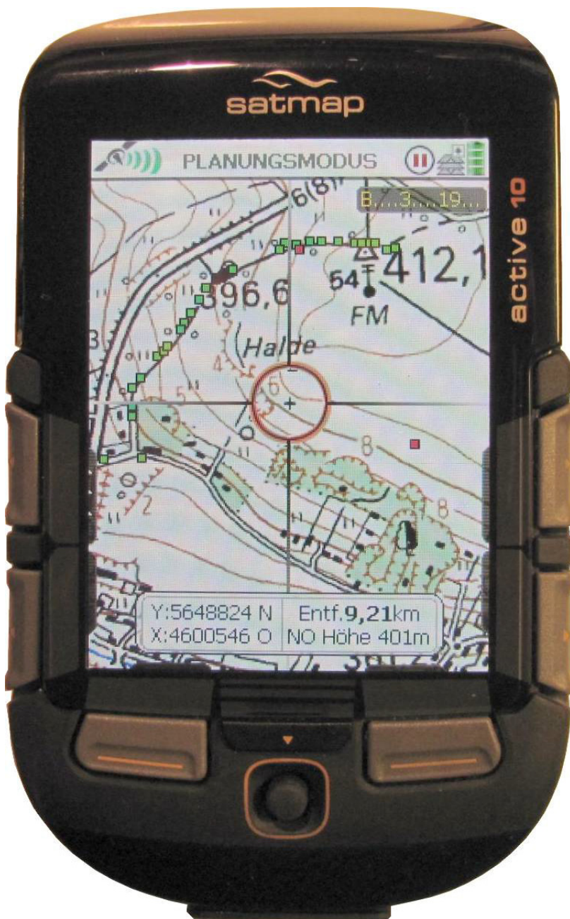
Abb. 4: Das Satmap Active 10 im Planungsmodus. Abgebildet ist ein Ausschnitt der TK25 Blatt 5046 (Freiberg) im willkürlich gewählten Bearbeitungsmaßstab 1 : 14 600. Hier können beispielsweise Aufschlusspunkte in die Karte eingetragen oder bearbeitet werden. Es ist möglich vorgegebene oder eigene Symbole zu benutzen. Für die Satmap-Aufschlusskarte werden ausschließlich eigene Symbole sowie das Gauss - Krüger - Koordinatensystem RD 83 verwendet.
