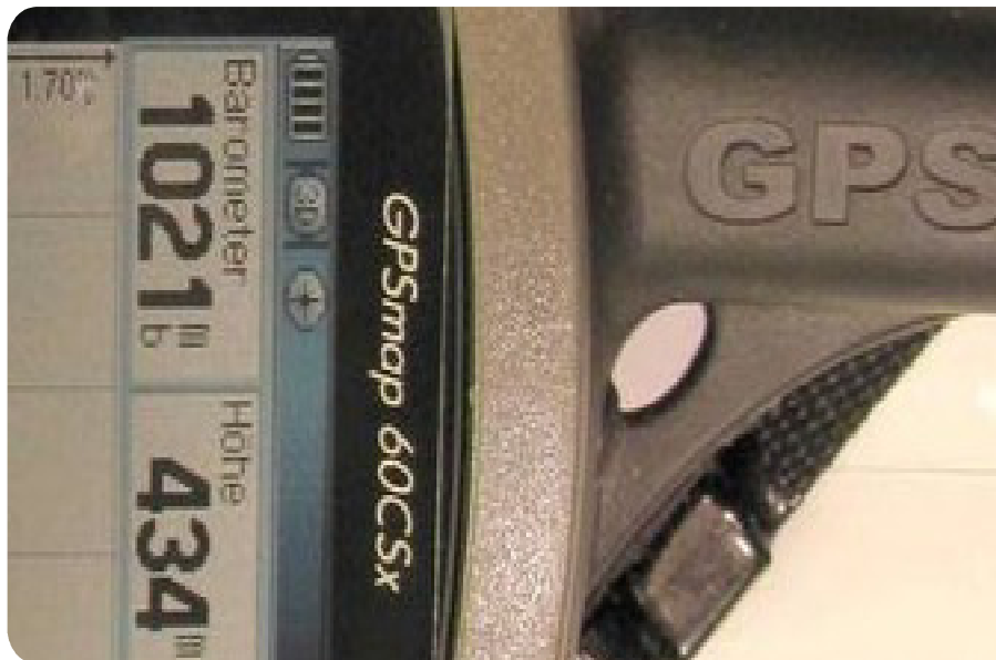
Abb.1: Das inzwischen vom 62CSx abgelöste Garmin-Gerät, hier bei ausgeschalteter Hintergrundbeleuchtung, arbeitet wahlweise mit GPS- oder barometrischer Höhenmessung. Bei gleichen Luftdruckverhältnissen lief das GPSmap 60CSx ohne Neukalibrierung über viele Monate bis auf 1 Meter sehr genau. Kalibrierung und Vergleichsmessungen erfolgten zu Testzwecken über lange Zeiträume an Topographischen Höhenmesspunkten.
